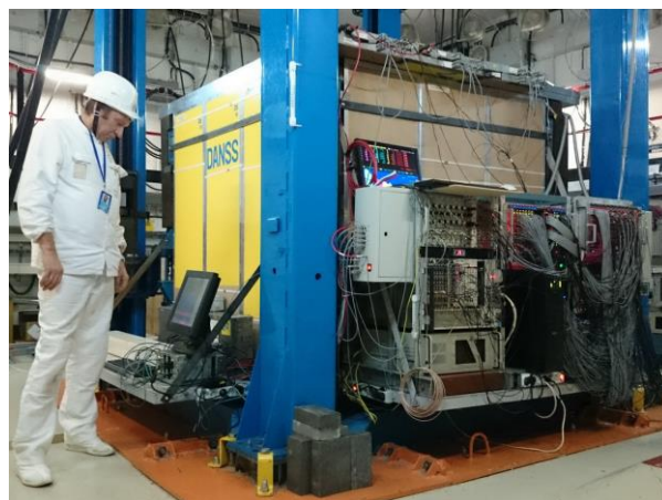
Рис. 2. Слева: детектор в процессе монтажа 2500 стрипов. Справа: работающий детектор DANSS на подъемной платформе в нижнем положении.
