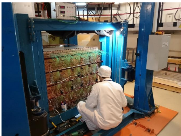
Рис. 2. Слева: детектор в процессе монтажа 2500 стрипов. Справа: работающий детектор DANSS на подъемной платформе в нижнем положении.
