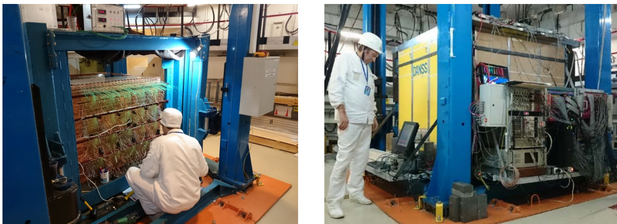
Рис. 2. Слева: детектор в процессе монтажа 2500 стрипов. Справа: работающий детектор DANSS на подъемной платформе в ее нижнем положении.
