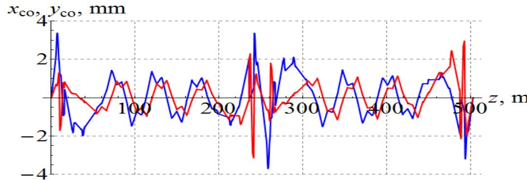
Искажение замкнутой орбиты при случайных сдвигах квадрупольей.
