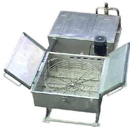
Очистка изделий и деталей
