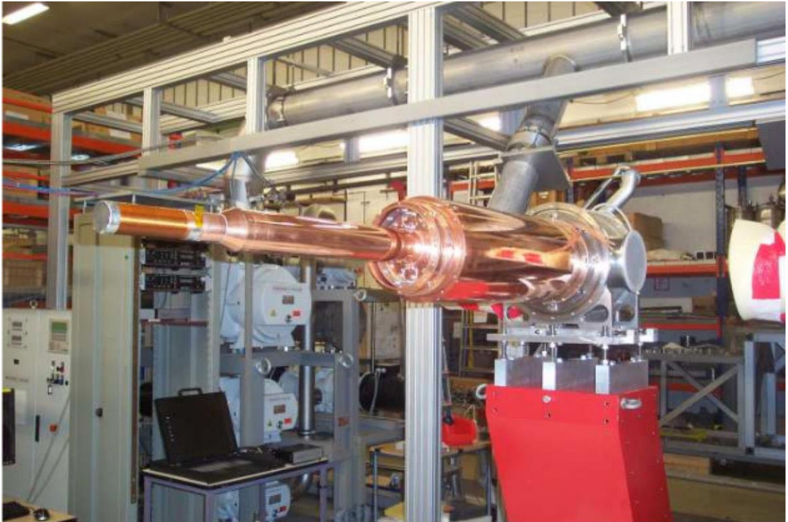
Рис. 7: Новый рефрижератор растворения для мишени с замороженной поляризацией ядер внутри детектора "Crystal Ball".
