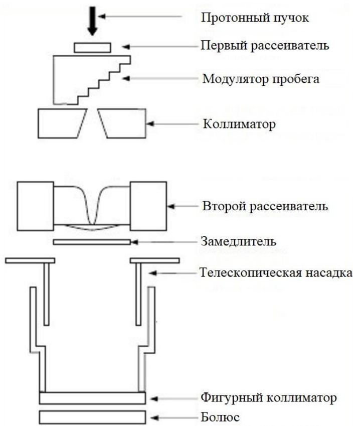
Рис. 1. Схема формирования терапевтического пучка в процедурной кабине
