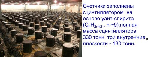
Счетчики заполнены сцинтиллятором на основе уайт-спирита (C<sub>n</sub>H<sub>2n+2</sub>, n ≈ 9); полная масса сцинтиллятора 330 тонн, три внутренние плоскости - 130 тонн.
