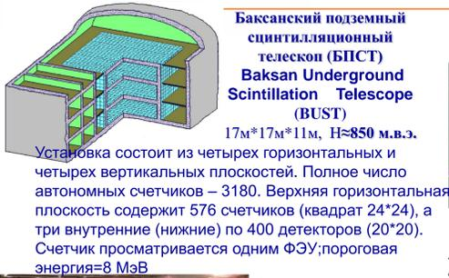
**Баксанский подземный сцинтилляционный телескоп (БПСТ) Baksan Underground Scintillation Telescope (BUST)**
