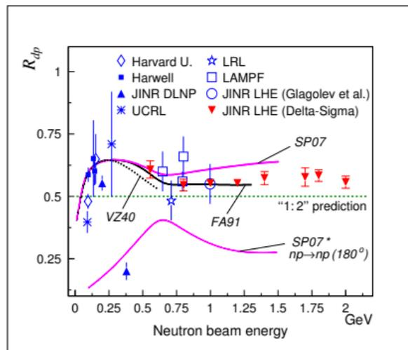
Энергетическая зависимость  $R_{dp}$ -отношения выходов протонов квазиупругой  $nd \rightarrow p(nn)$  и упругой  $np \rightarrow pn$  реакций перезарядки при рассеянии под нулём.
