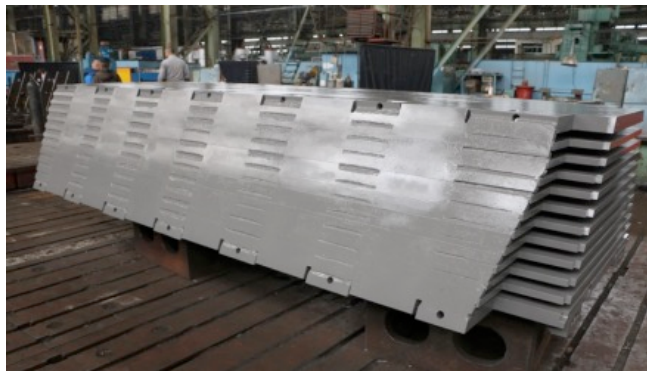
Рис.7. Модуль цилиндрического детектора (один из восьми), изготовленный на новосибирском заводе.
