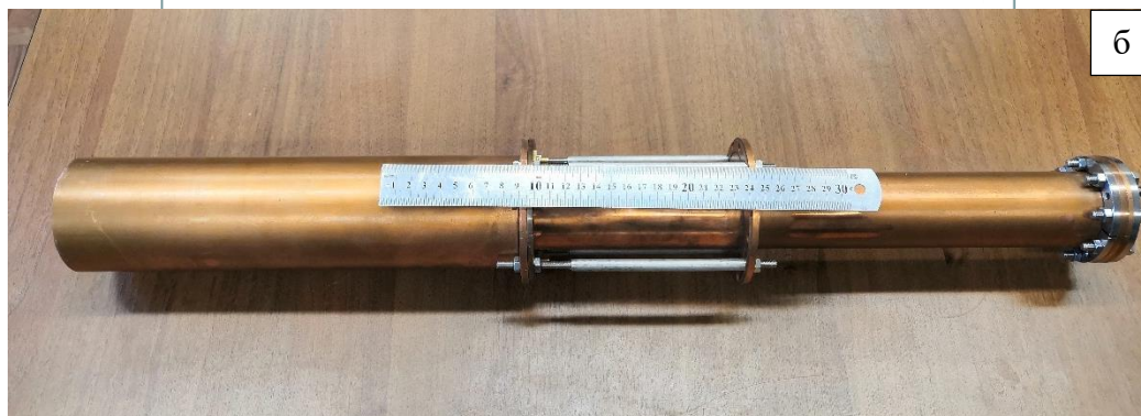
Рис. 5. а. Функция U_{RF}(t) и функция U_3(t) , восстановленная по 3 гармоникам, б. Резонатор системы упорядочения потока монохроматических позитронов.
