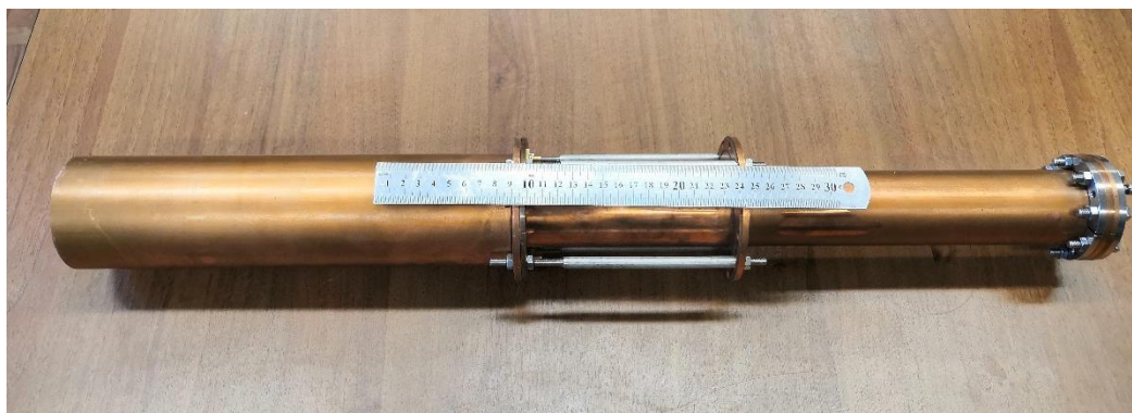
Рисунок 2. Резонатор системы упорядочения позитронов.
