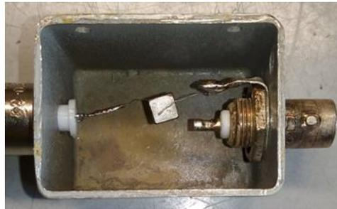
**Fig. 21.**  $\text{LiInSe}_2$  crystal ( $5 \times 5 \times 1.5 \text{ mm}^3$ ).
