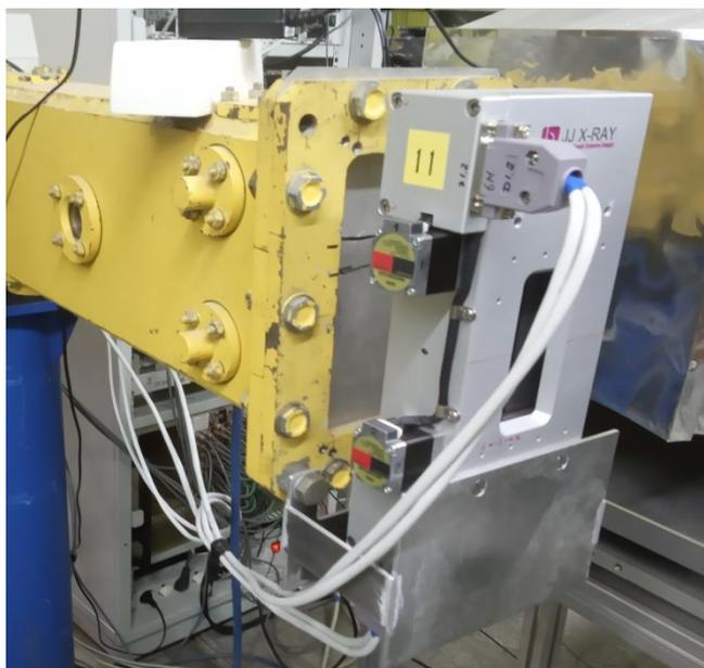
**Рис. 29.** Диафрагма «JJ X-RAY» на дифрактометре ФСД.
