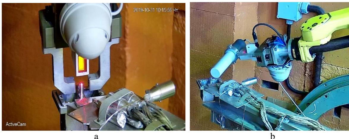
**Рис. 4.** Фотографии роботизированного манипулятора, сделанные при помощи одной из видеокамер аппаратного комплекса видеонаблюдения и измерения расстояний: **а** – пневматический захват манипулятора в момент снятия контейнера с высокоактивным образцом; **б** – измерение дозы локальным дозиметрическим комплексом в момент перед снятием манипулятором контейнера с образцом (мощность дозы на поверхности контейнера в момент снятия  $\sim 78$  мЗв/ч).
