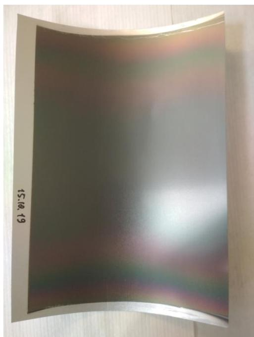
**Рис. 16.** Образец напылённой пленки  $V_4C$  на алюминиевую подложку (толщина пленки в центральной части 2 мкм).
