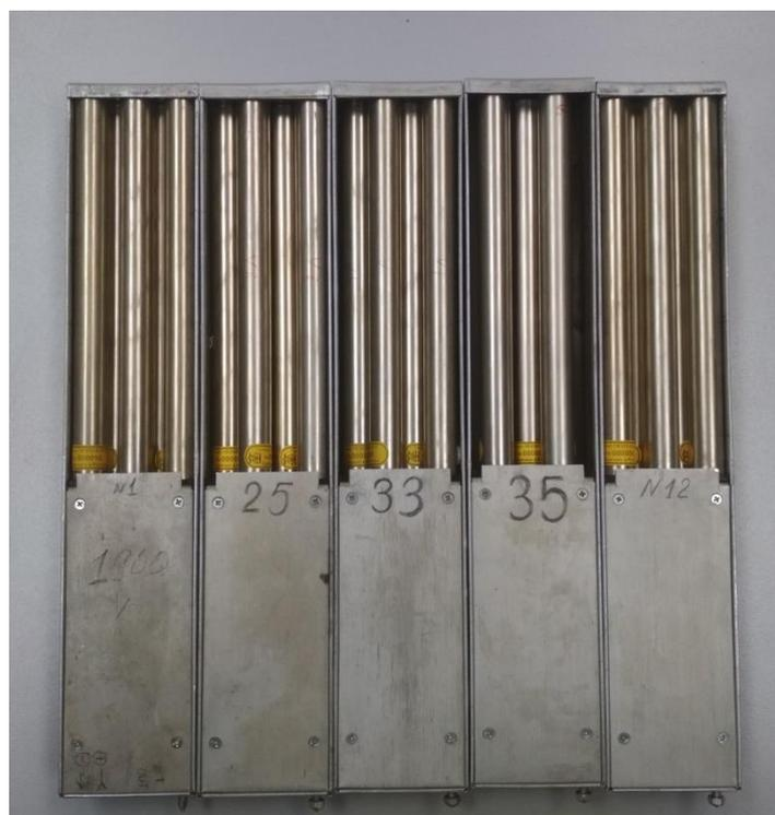
**Рис. 15.** Варианты детекторных модулей спектрометра НЕРА в сборе с предусилителем и защитой.
