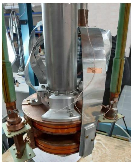
**Рис. 7.** ВТСП магнит и токовводы.
