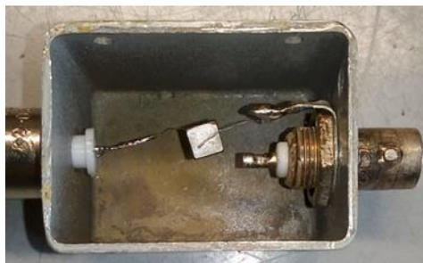
**Рис. 21.** Кристалл  $\text{LiInSe}_2$  ( $5 \times 5 \times 1,5 \text{ mm}^3$ ).
