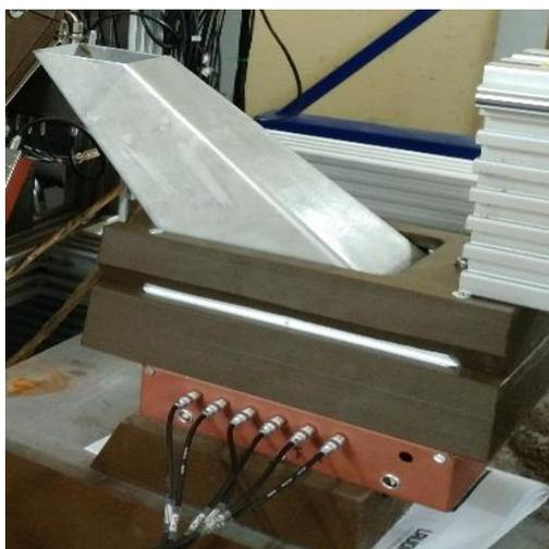
Рис. 18. Модуль 45-градусного кольцевого детектора спектрометра ДН-6.
