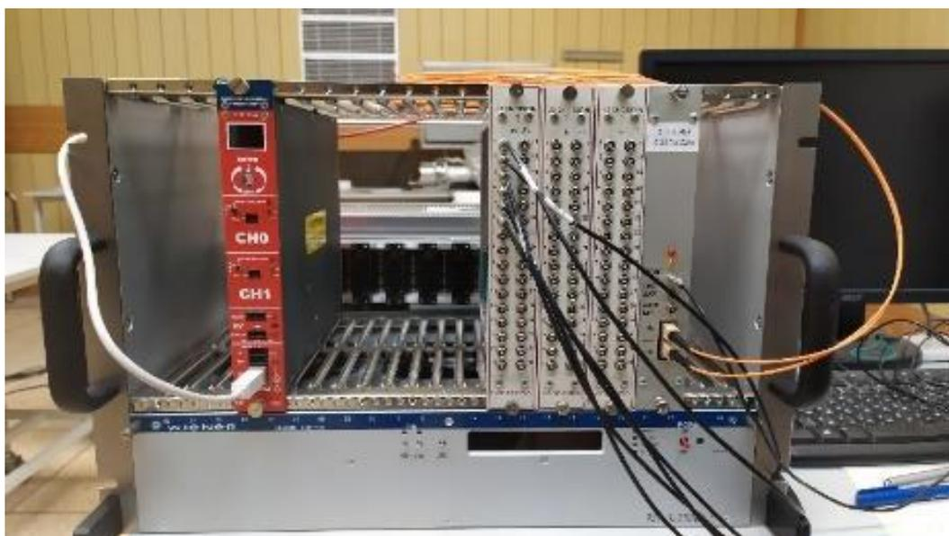
Рис. 19. 96-канальная система накопления данных для спектрометра ДН-6.
