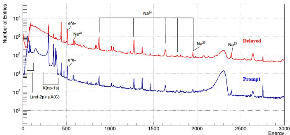
**Рисунок 3.** Коррелированные мезорентгеновский (синий) и задержанный (красный) спектры, измеренные с помощью обогащенной мишени  $^{24}\text{Mg}$ . На рисунке указаны некоторые идентифицированные гамма-переходы, а также мезорентгеновские переходы магния (K (np-1s) и L (nd-2p) серии) и углерода (mX(C)).
