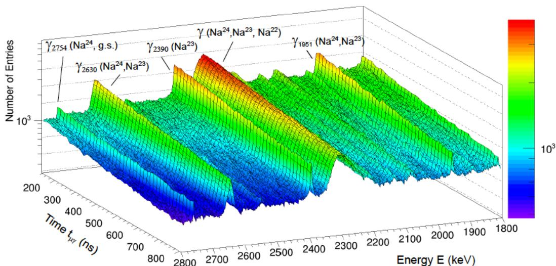
**Рисунок 4.** (E, t) распределение коррелированных событий, измеренных с мишенью  $^{24}\text{Mg}$ . На рисунке указаны некоторые гамма-переходы, соответствующие захвату мюона в ядре, прослеживая временную эволюцию которых определяются полные скорости мюонного захвата.
