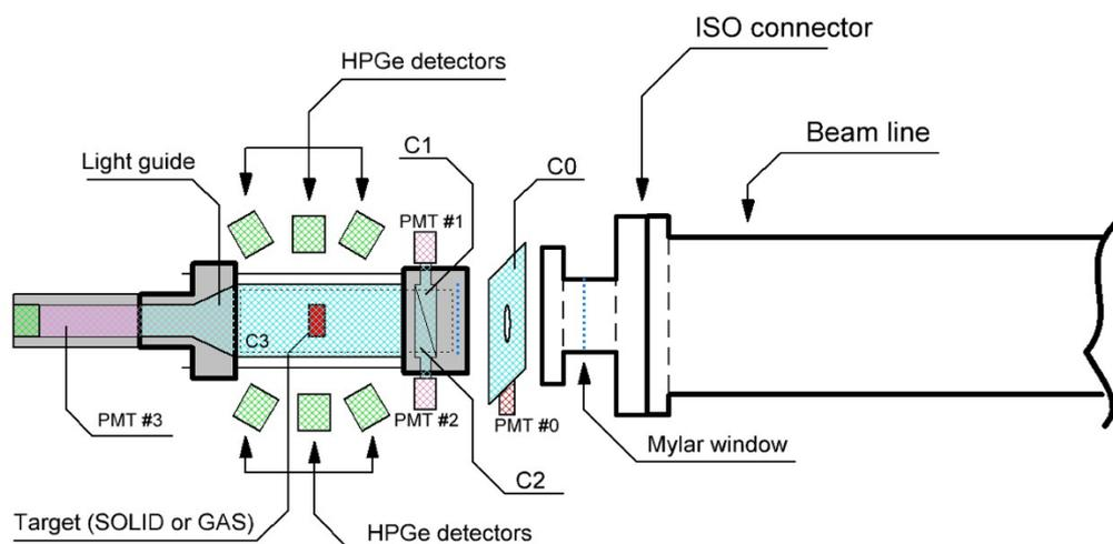
**Рисунок 2.** Схема экспериментальной установки: формирующее входное окно (сцинтилляционный вето-счетчик C0), пролетные счетчики (C1, C2), сама мишень, вето-счетчик (C3) и HPGe  $\gamma$ -детекторы, расположенные вокруг мишени. Корпус мишени сконструирован для размещения как твердых, так и газообразных материалов.
