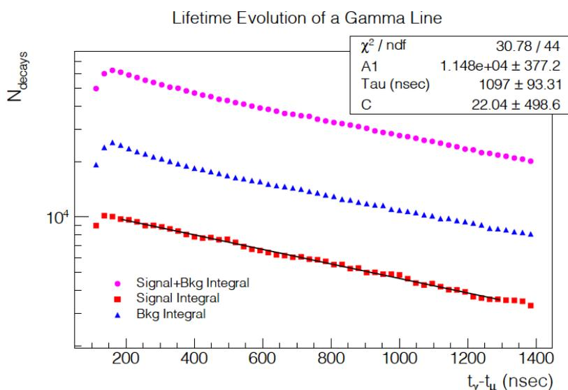
**Рисунок 5.** Временная эволюция гамма-линии 2390,6 кэВ, измеренная с мишенью  $^{24}\text{Mg}$ . Фиолетовая кривая отражает эволюцию интеграла центральной части фрагмента (сама линия + фон под ней); синяя кривая - площадь фона вокруг линии; красная кривая отражает эволюцию самой гамма-линии, фитированной Гауссианом с пятью параметрами по каждому временному срезу.
