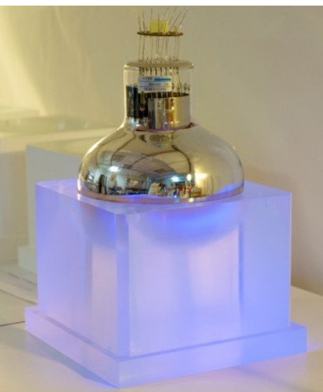
Calo. Optical Module FWHM 7-8 % @ 1 MeV
