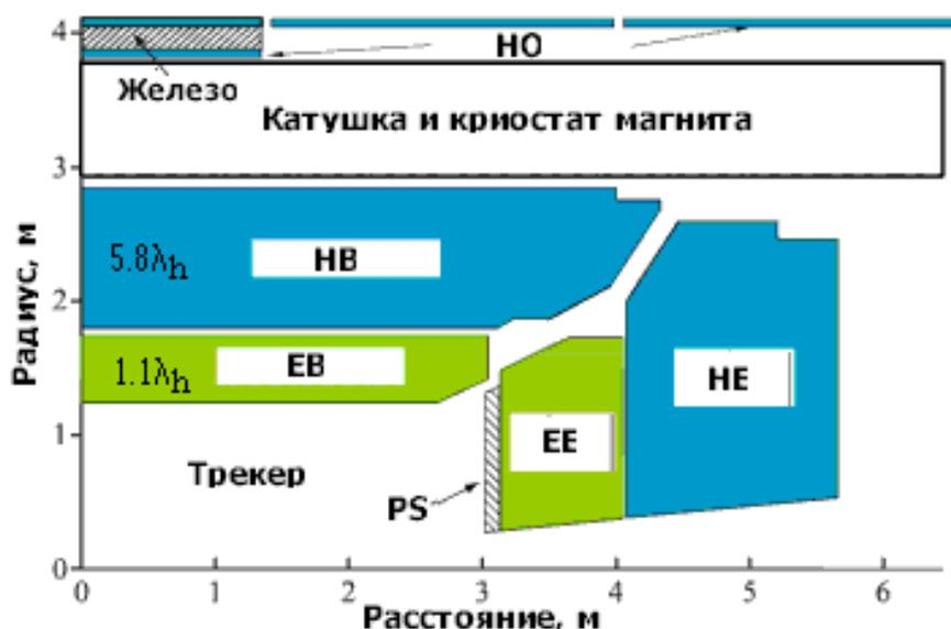
Рис. 4.1. Схема организации адронной калориметрии CMS.
