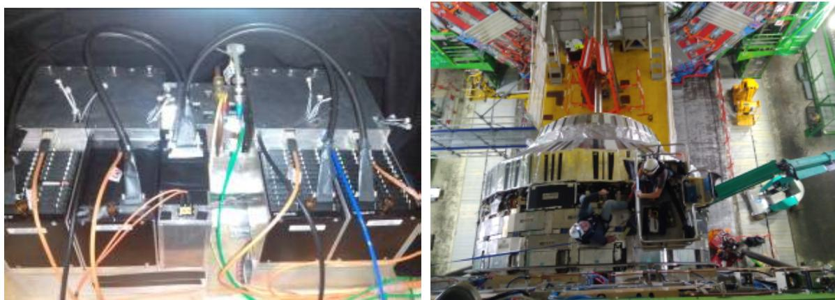
Рис. 4.8. (слева) Общий вид модулей считывания, установленных в крейте считывания – так называемая система регистрирующей электроники. (справа) Процесс установки системы регистрирующей электроники в торцевые адронные калориметры, вид сверху.
