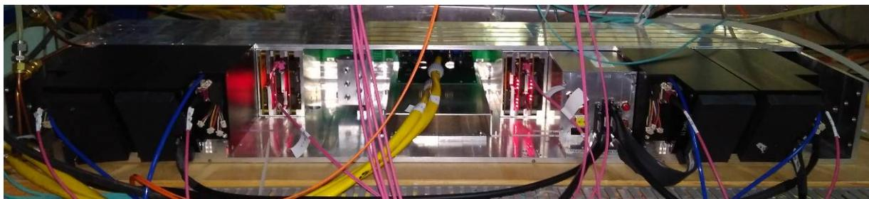
Рисунок 4.11. Общий вид модулей регистрирующей электроники и модулей контроля, установленных в крейте считывания – так называемая система регистрирующей электроники.
