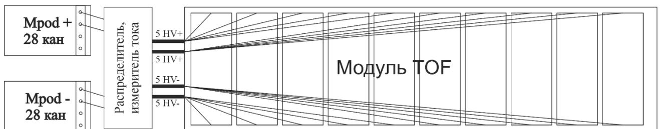
Рисунок 4.23 – Схема распределения высокого напряжения для одного модуля TOF MPD
