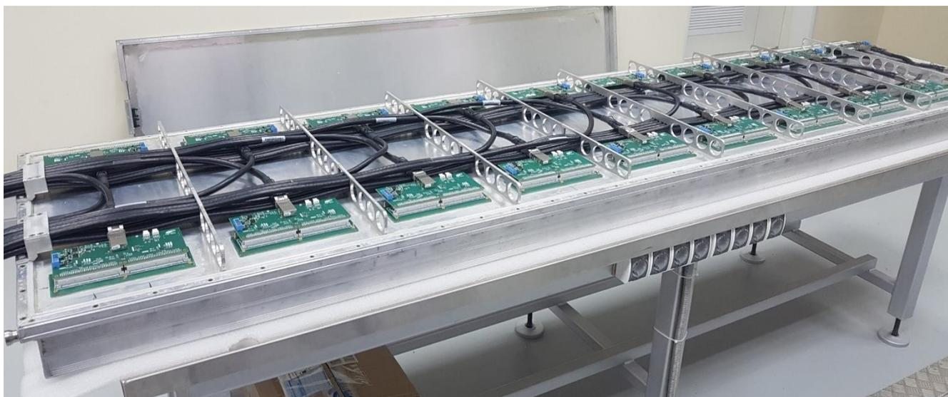
Рисунок 4.3 – Расположение усилителей и сигнальных кабелей во внешнем объеме модуля TOF
