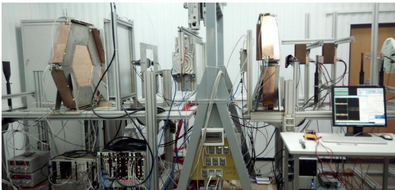
Рисунок 3.29 – Общий вид установки «Тестовый канал MPD» во время работы с пучком
