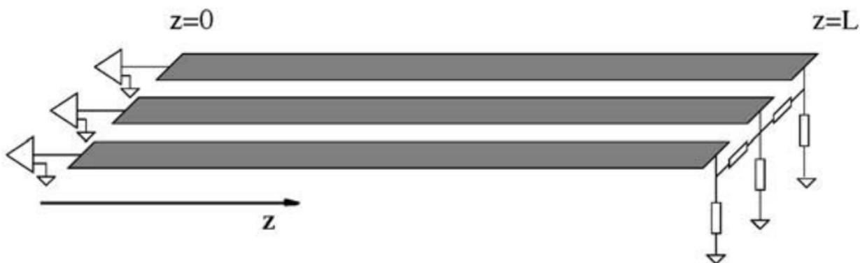
Рисунок 2.10 – Стрипы РПК как двумерная многопроводная линия передачи сигнала.
