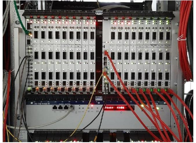
Рисунок 4.15 – Крейт VME VXs с модулями ВЦП, триггерным и синхронизационным модулем
