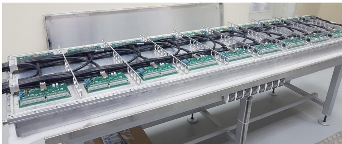
Рис. 18 – Расположение усилителей и кабелей в модуле.
