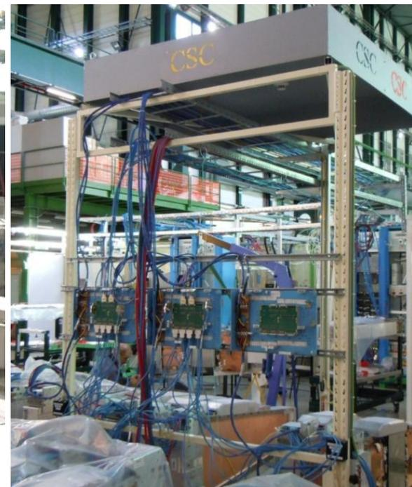
Стенд для длительной проверки камер
