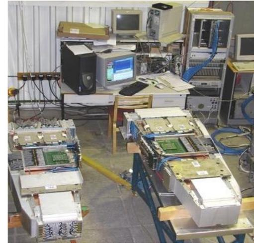
Автоматизированный стенд для проверки характеристик камер ME1/1
