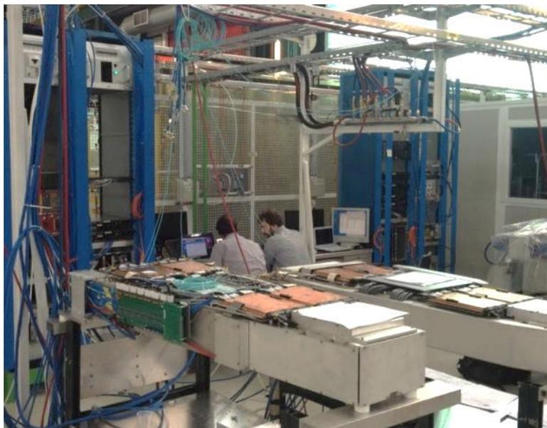
Стенд для проверки камер после сборки
