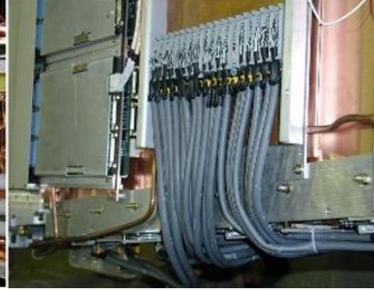
После монтажа системы охлаждения и кабелей, на камеру устанавливались платы считывания информации
