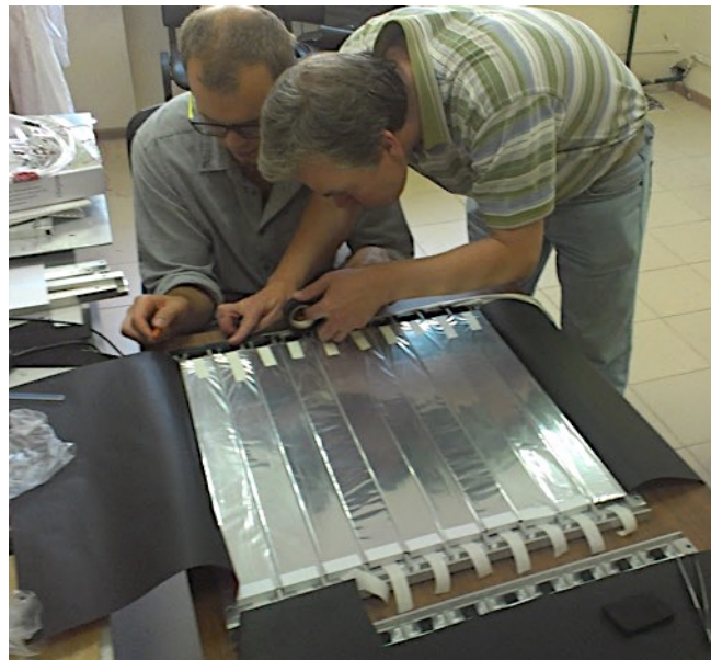
Fig. 2.2.1.39. Production of the scintillation planes.
