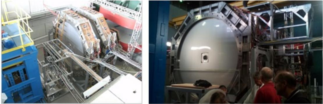
Рис. 36. Дрейфовые камеры внешнего трекера установки *BM@N*.
