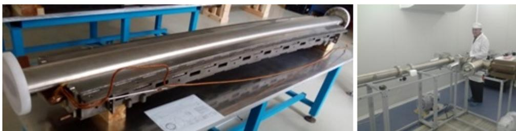
Рис. 15. Вакуумная камера дипольного магнита (слева) и стенд для испытания элементов вакуумной системы Бустера (справа).
