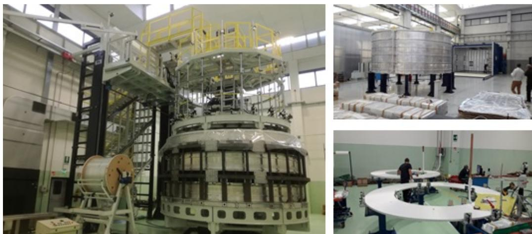
Рис. 24. Первый модуль сверхпроводящей катушки соленоида на намоточной машине (слева), первый модуль опорного цилиндра сверхпроводящей катушки и печь компаундирования (справа вверху), намотка теплых обмоток торцевых корректирующих магнитов (справа внизу).
