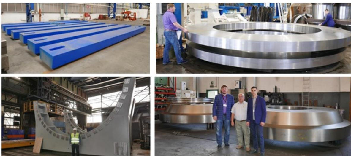
Рис. 25. Балки магнитопровода (слева вверху), ложементы для их поддержки (слева внизу), поддерживающие кольца (справа)
