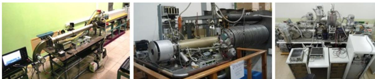
Рис. 7. Действующие источники заряженных частиц комплекса NICA: лазерный (слева, на врезке – источник питания Nd-YAG лазера), электронно-струнный КРИОН-6Т (в середине) и поляризованных ионов (справа).
