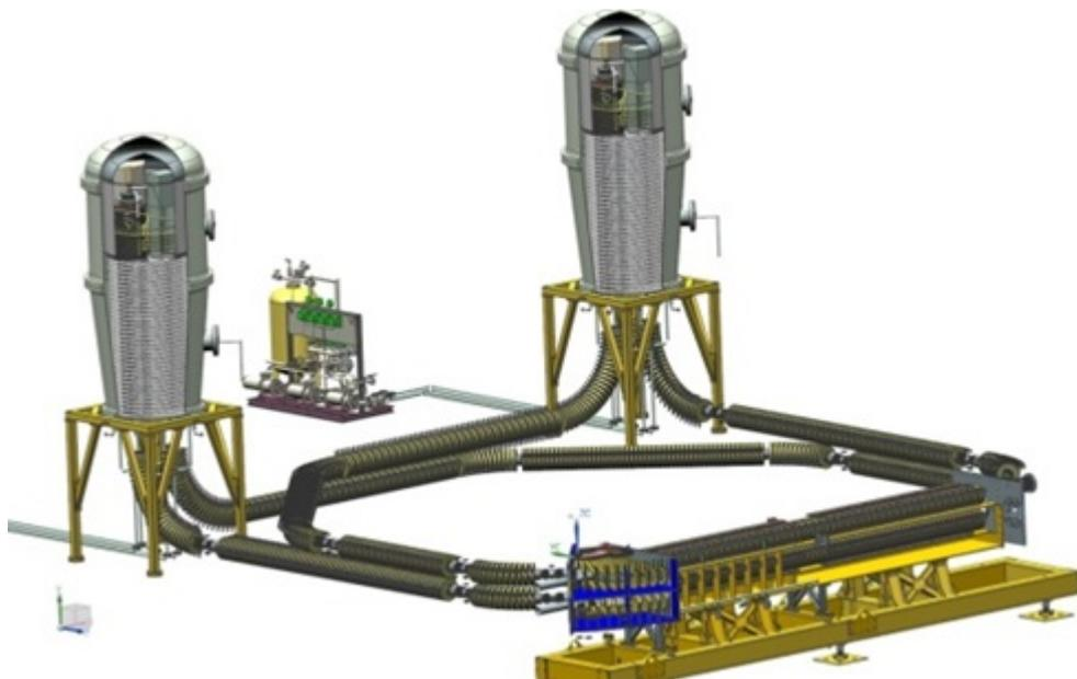
Рис. 20. Общий вид системы электронного охлаждения пучков Коллайдера NICA (проект ИЯФ им. Г.И.Будкера СО РАН).
