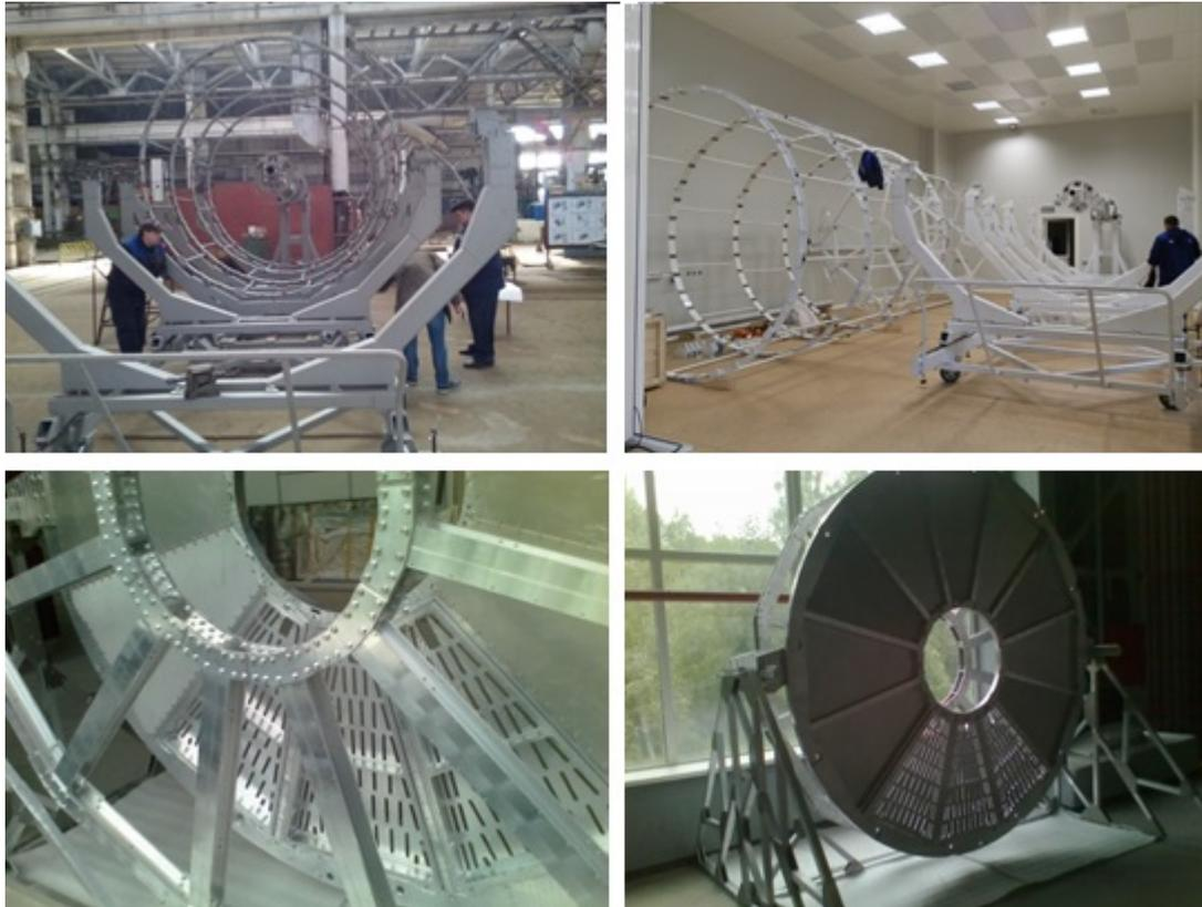
Рис. 29. Оснастка для монтажа и сборки RPC во время производства и в чистой комнате ЛФВЭ ОИЯИ (сверху) и фланцы и прототип сервисного «колеса» RPC (внизу).
