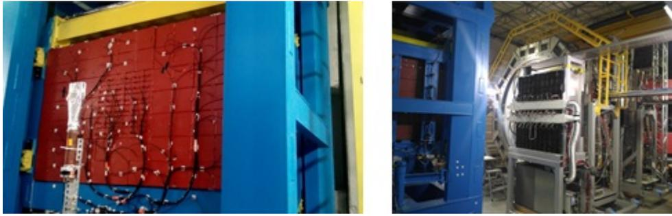
Рис. 38. Адронный калориметр малых углов ZDC на подвижной платформе (слева) и элемент электромагнитного калориметра ECAL (справа) установки BM@N.
