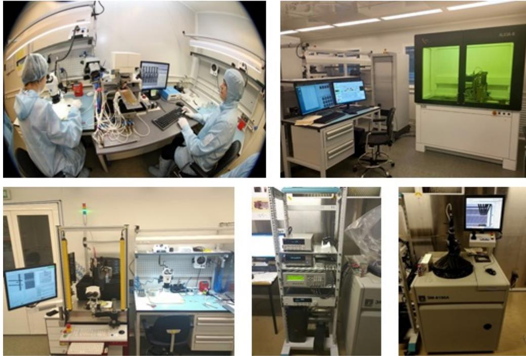
Рис. 34 Участок сборки модулей микроstriповых детекторов и робот-укладчик MAPS (вверху); участок сборки и сертификации трековых систем с измерительным стендом для сертификации двусторонних микроstriповых сенсоров (внизу).
