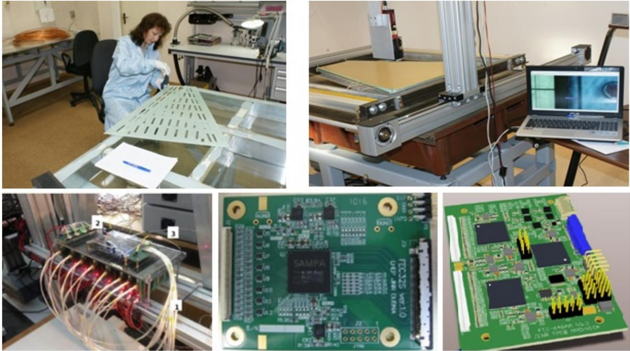
Рис. 28. Создание и тестирование считывающих камер ТРС (сверху); 512-канальная система считывания данных на базе чипов PASA и ALTRO (внизу слева), 32-канальная плата (внизу посередине) и 64-х канальная (внизу справа) платы считывающей электроники на базе чипа SAMPA.
