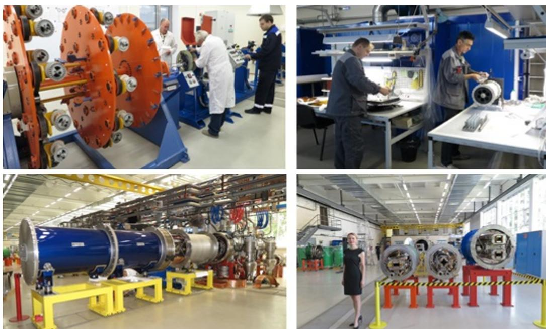
Рис. 11. Станок для намотки сверхпроводящего кабеля (слева сверху), участок для изготовления обмоток магнитов (справа сверху), участок криогенных испытаний магнитов (внизу слева) и образцы собранных магнитов в криостатах (внизу справа - дипольный и квадрупольный магниты Бустера и двухапертурный дипольный магнит для двух колец Коллайдера).
