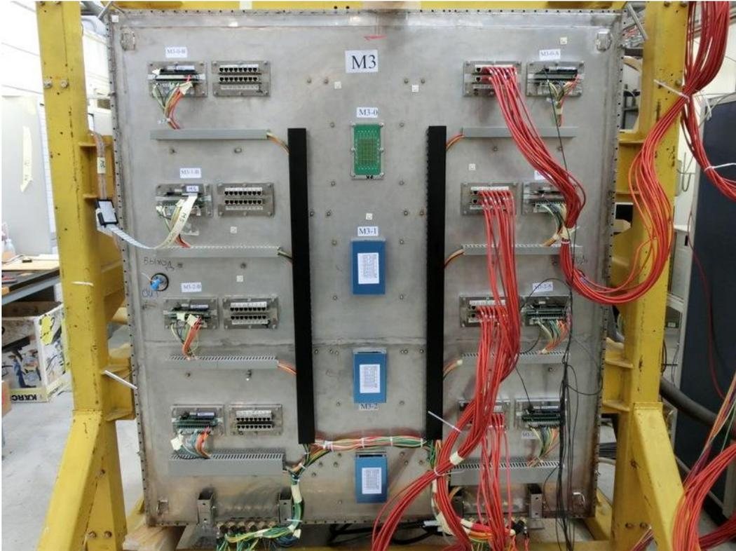
Рис. 9. Модуль с закрытой крышкой. Все соединения с картами снаружи осуществляются через герметичные фланцы.
