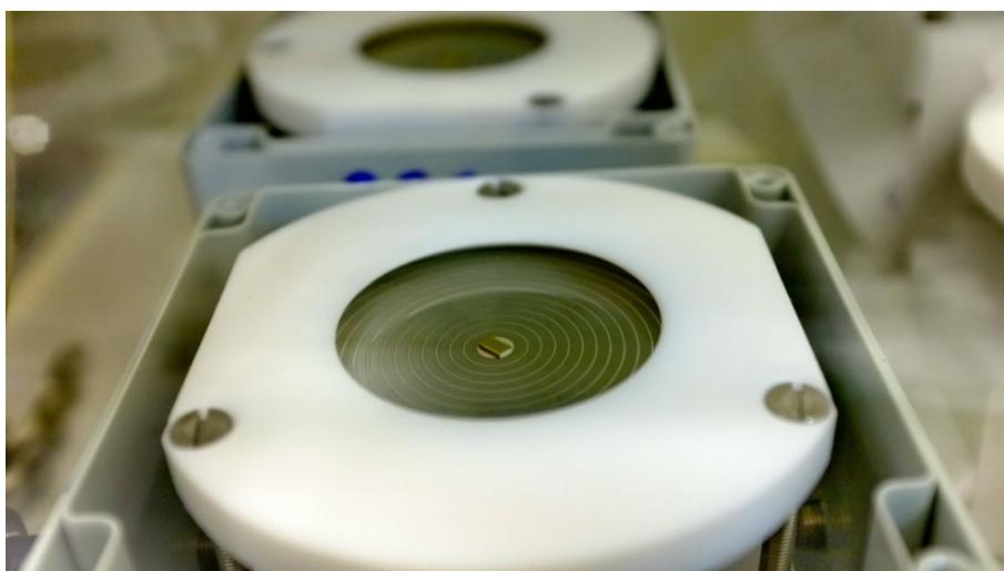
**Рис. 1:** HPGe детекторы-болометры, разработанные EDELWEISS для прямого поиска частиц темной материи.
