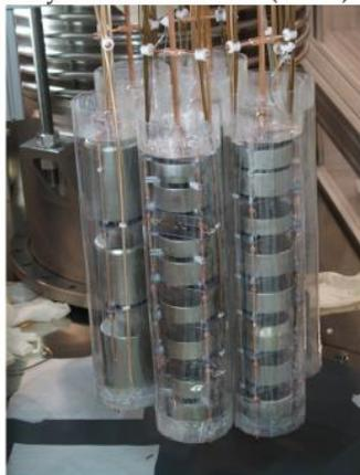
Разработанный NMS обладает хорошей радиоактивной чистотой, стабилен в жидком аргоне, улучшает работу аргонового вето и позволяет в комбинации с PSD уменьшить уровень фона в области интереса более чем в 1000 раз.
