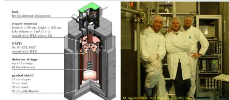
Для детального изучения фона от  $^{42}\text{Ar}$ , был искусственно произведен  $^{42}\text{Ar}$  и добавлен в жидкий аргон криостата LArGe. Были разработаны и протестированы различные способы подавления фона от  $^{42}\text{Ar}$ .
