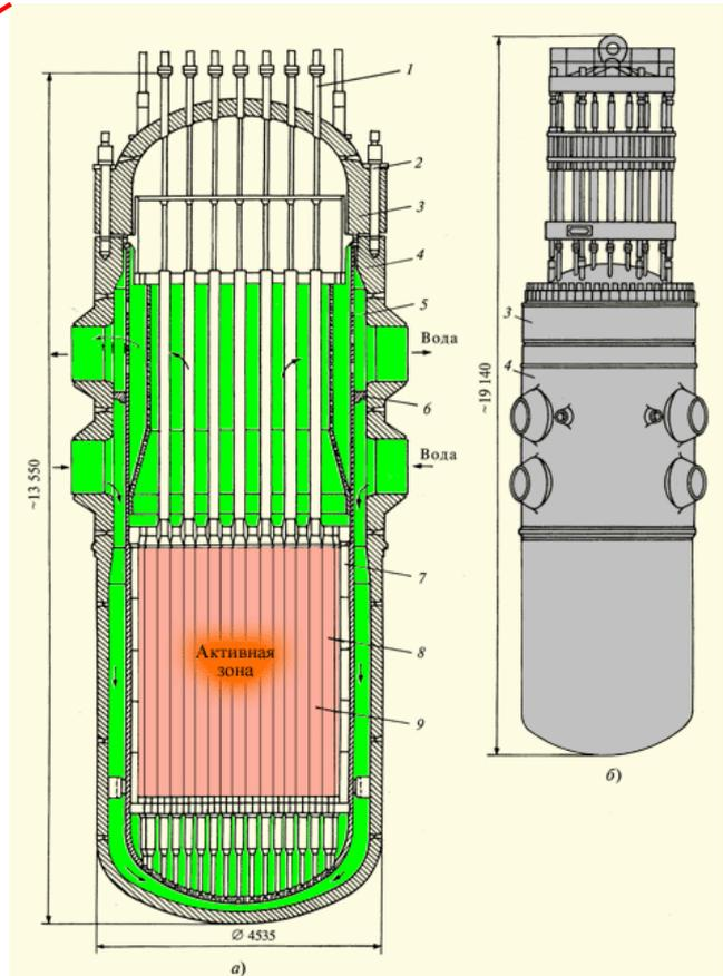
Рис. 5.4. Ядерный реактор ВВЭР-1000
