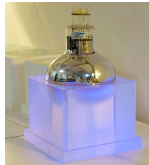
Calo. Optical Module FWHM 7-8 % @ 1 MeV
