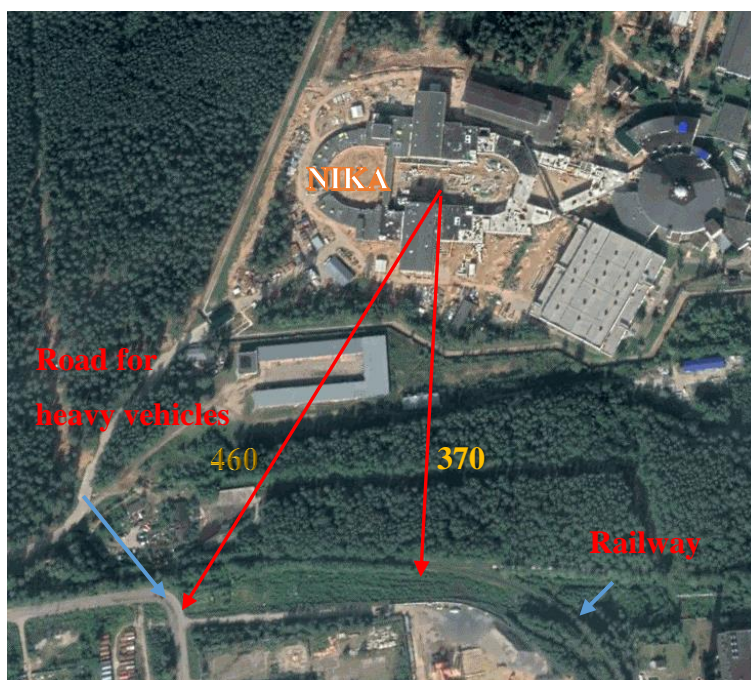
Рис.13 Расположение коллайдера НИКА относительно основных источников микросейсмических шумов (автомобильная и железная дороги)
