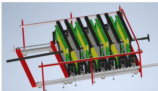
Рис. 3.3.6. Конструкция механики для точной установки плоскостей GEM внутри магнита СП-41.
