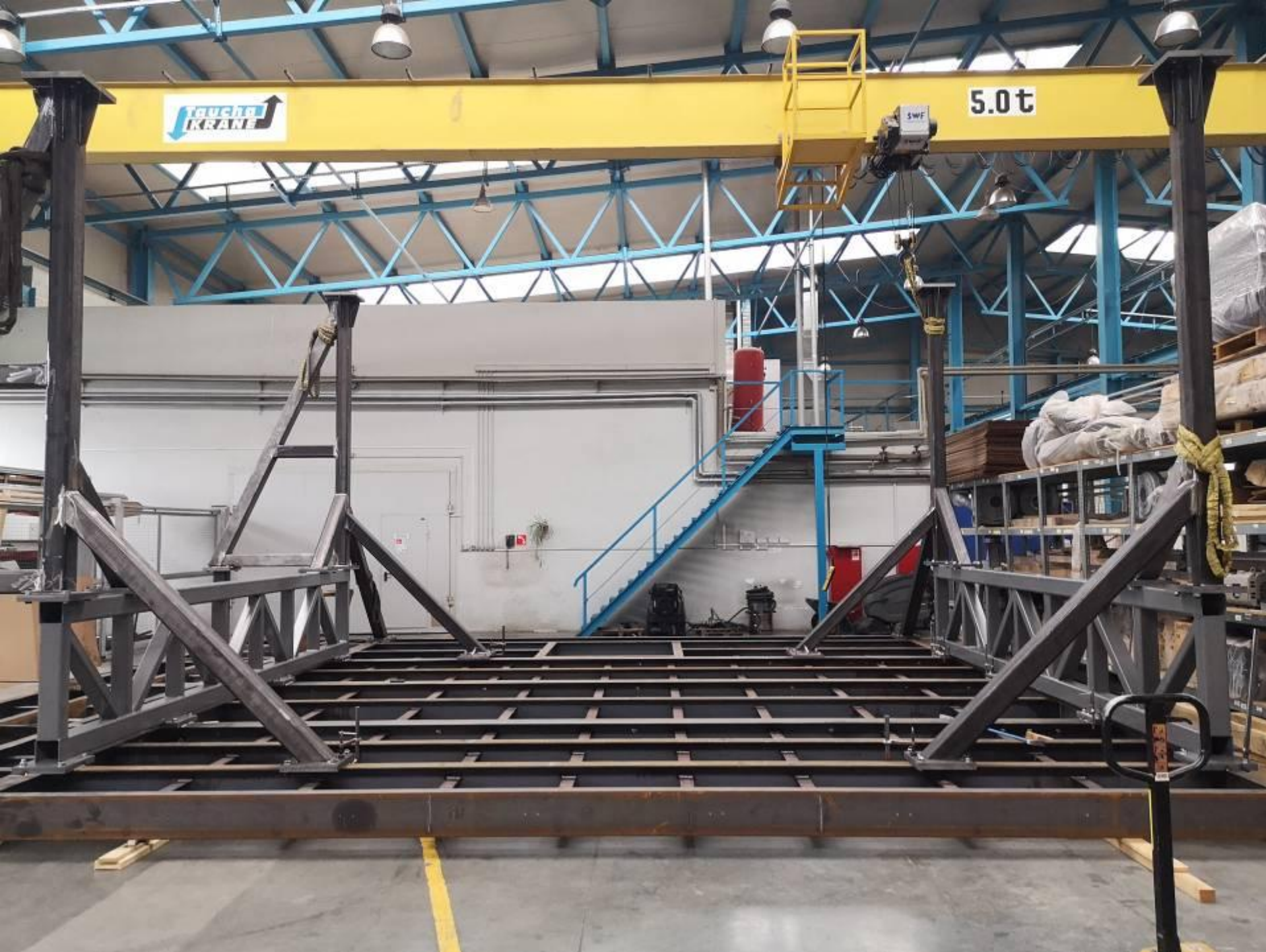
Верхняя платформа для детектора MPD (фото сделано на заводе «Пелком»)
