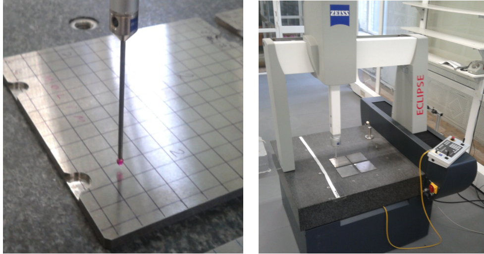
Рис. 6: Измерение геометрических параметров пластин вольфрамового поглотителя FCAL с использованием трехосевой координатно-измерительной машины Zeiss Eclipse.
