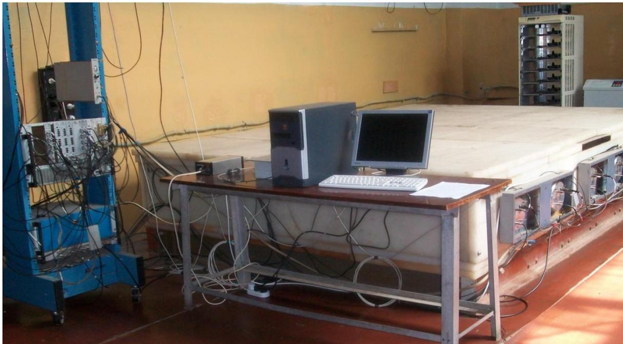
НМ стандартного типа 6НМ64 площадью 6 кв.м. состоит из свинцового генератора, полиэтиленового замедлителя и шести пропорциональных борных счетчиков типа СНМ15 (15 × 200) кв.см, заполненных газом ВF3 под давлением 0.2 атм.
