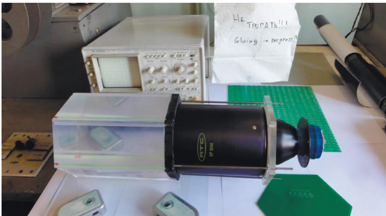
Рис.8 Детектор нейтронов в процессе сборки.
