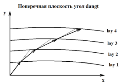
Рисунок 4. Схематическое представление угла dangle в поперечной плоскости
