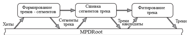
Рисунок 2. Схема программы реконструкции треков частиц в вершинном детекторе ITS
