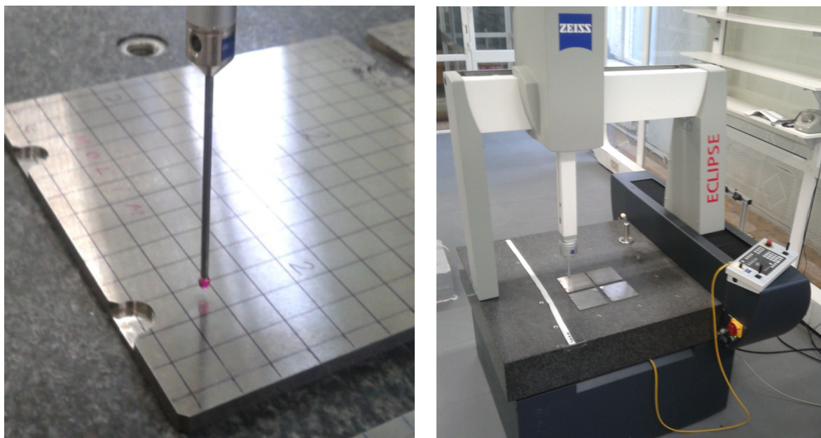
Рис. 7: Измерение геометрических параметров пластин вольфрамового поглотителя FCAL с использованием трехосевой координатно-измерительной машины Zeiss Eclipse.
