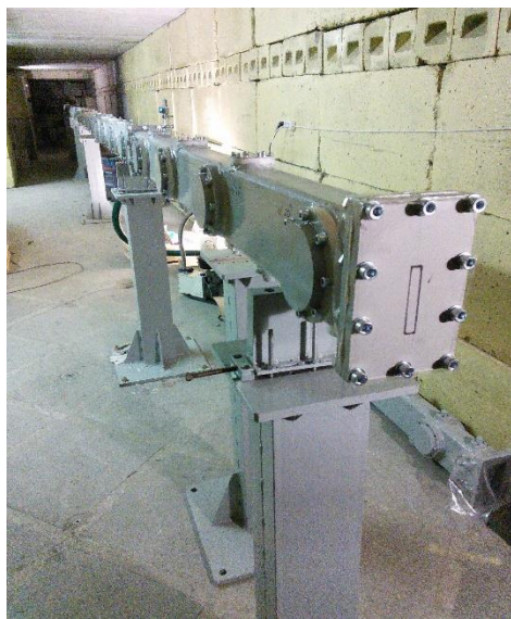
Рис. 49. Новый зеркальный нейтроновод спектрометра спин-эхо малоуглового рассеяния на 9 канале ИБР-2 (слева). Спектральное распределение плотности потока падающих нейтронов в месте расположения образца с новым нейтроноводом (красные символы) и в старой конфигурации (черные символы), справа.
