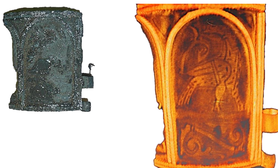
Рис. 35. Фотография фрагмента древнерусского браслета из клада, обнаруженного в г. Тверь (слева) и его 3D реконструкция по данным нейтронной томографии (справа).
