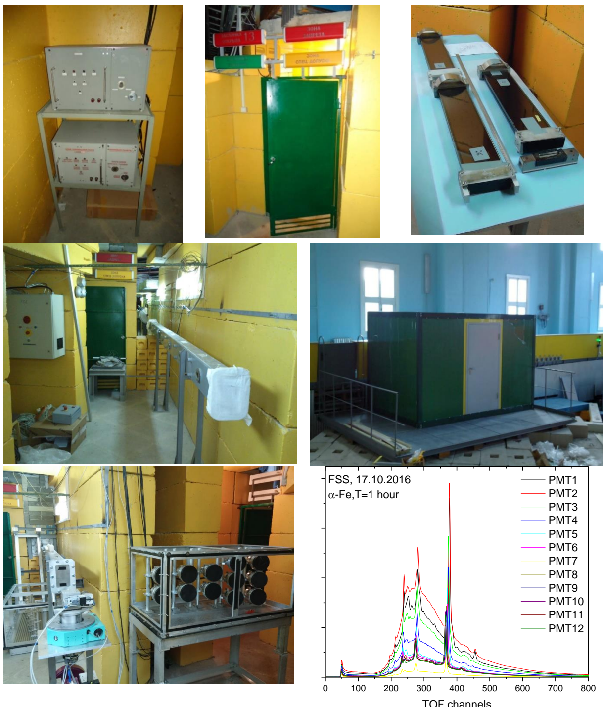
Рис. 45. Фурье-дифрактометр FSS на 13-канале ИБР-2 (сверху-вниз и слева-направо): пульта оперативного управления шибером (ПОУШ) и заслонкой (ПОУЗ); входная дверь в бункер (место вывода пучка); стеклянные секции зеркального нейтропровода перед установкой в кожух; установленный нейтропровод в стальном кожухе и электроника управления фурье-прерывателем; домик экспериментатора на биологической защите каналов № 13-14; детектор Ost (без защиты) после установки и юстировки 12-ти ФЭУ с приклеенными {}^6\text{Li} -стеклами; на месте образца установлены модули гониометра HUBER, адаптированные под стол FSS; TOF спектры от стандартного образца \alpha\text{-Fe} , измеренные отдельно каждым из 12-ти ФЭУ 90^\circ -детектора Ost на FSS.
