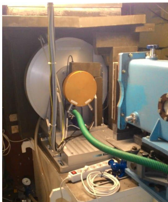
Рис. 40. Новый зеркальный нейтроновод с вертикальной параболической фокусировкой (слева) и новый фурье-прерыватель (справа) дифрактометра ФДВР.
