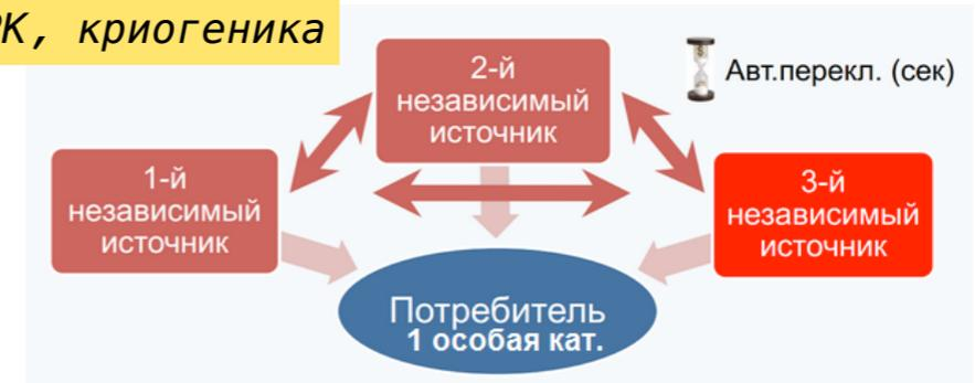
Это электроприемники, перерыв электроснабжения которых может повлечь за собой опасность для жизни людей, угрозу для безопасности государства, значительный материальный ущерб, расстройство сложного технологического процесса, нарушение функционирования особо важных элементов коммунального хозяйства, объектов связи и телевидения (п. 1.2.18 ПУЭ)
