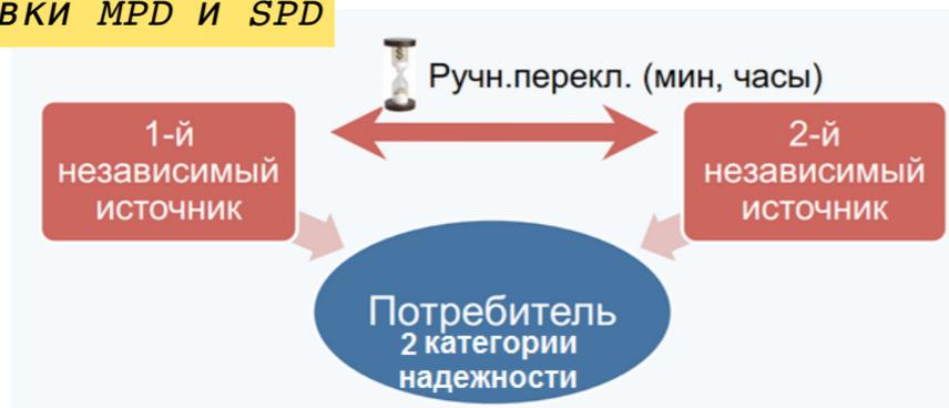
те электроприемники, перерыв в работе которых может привести к значительному снижению отпуска производимых потребителем товаров, имеющим место в связи с этим незанятостью персонала, простоем производственного оборудования или же может сказаться на нормальной жизнедеятельности большого количества граждан.
