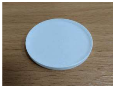
Гетерогенный сцинтиллятор. Содержание сцинтиллятора 35%. Компаунд Силикон
