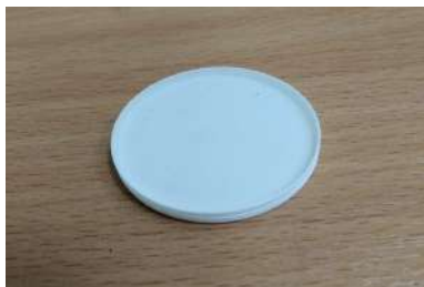
Гетерогенный сцинтиллятор. Содержание сцинтиллятора 35%. Компаунд эпоксидная смола
