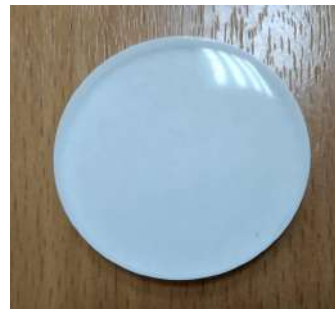
Гетерогенный сцинтиллятор. Содержание сцинтиллятора 35%. Компаунд эпоксидная смола
