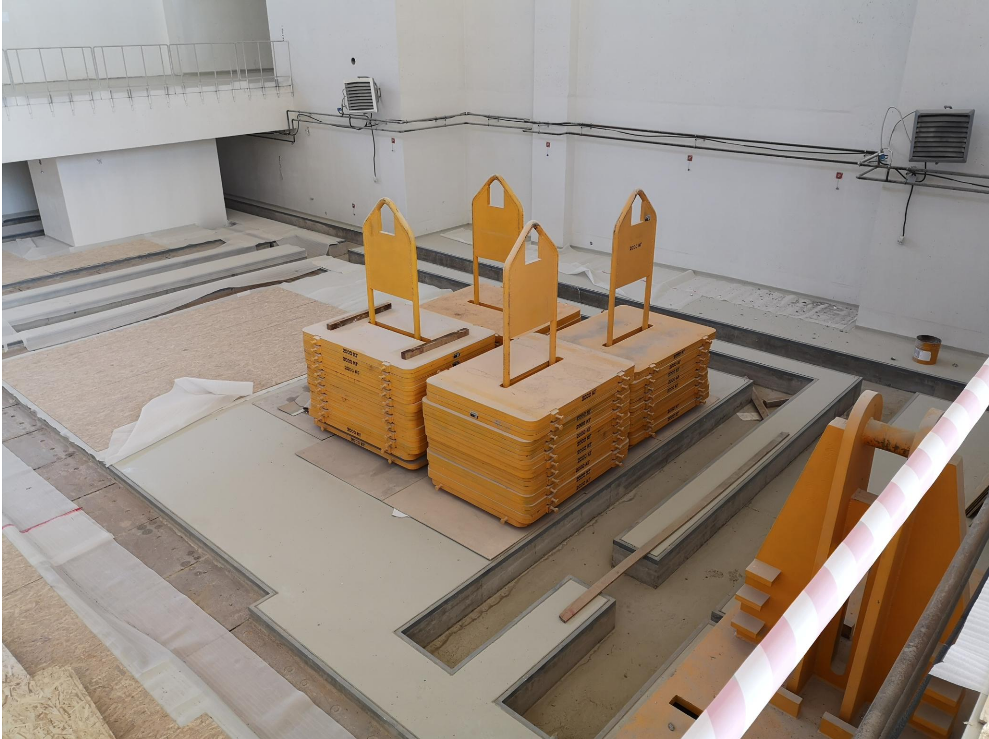
Тестовые грузы для испытаний крана и конструкций.
