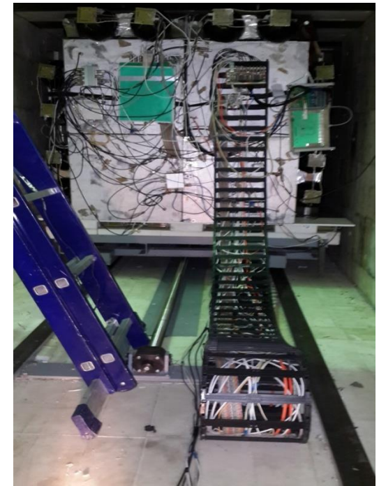
Сцинтилляционный детектор 50 секций 0,235x0,235x0,85м3
