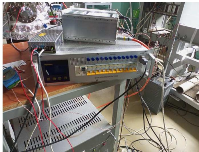
Испытано на стенде пушки, достигнут вакуум без использования титановых испарителей  $10^{-8}$  мбар.
