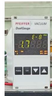
Вакуум в ускорительной трубке, предварительный прогрев в печи, без титановых испарителей (только магниторазрядный насос)
