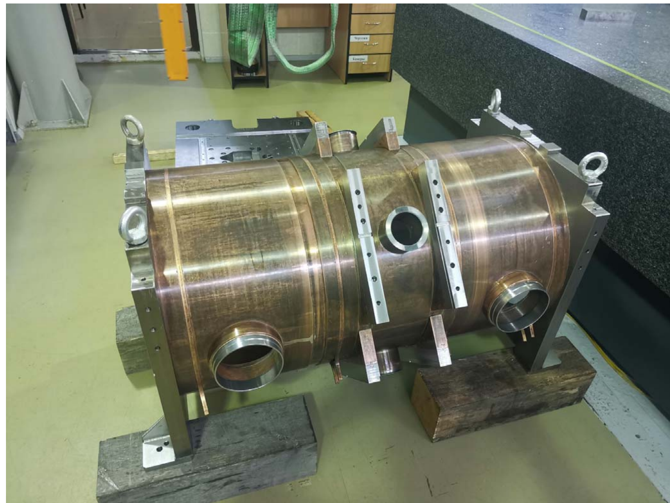
Корпус первого резонатора ВЧЗ
