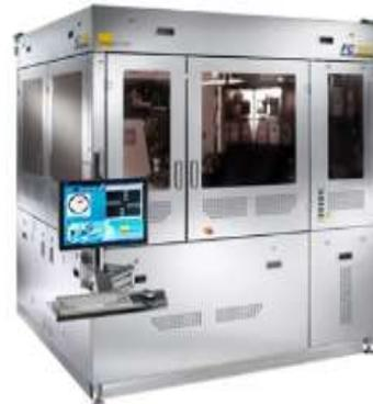
Термокомпрессионный высокоточный монтаж методом перевернутого кристалла (Flip-Chip).
