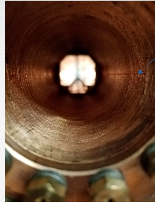
Проверка геометрии каркаса нивелиром перед намоткой
