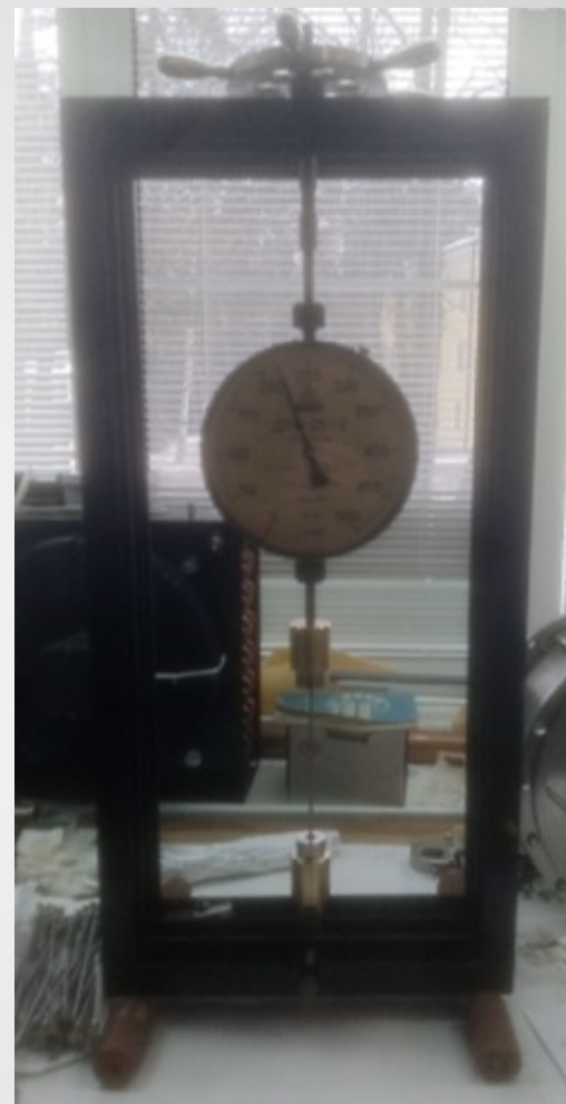
Испытания всех тяг двукратной нагрузкой
