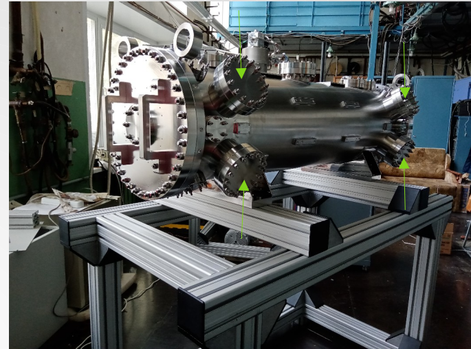
Выносные крепления азотных тяг
