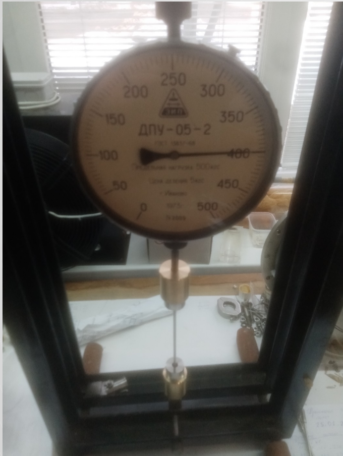
Выборочные испытания тяг
