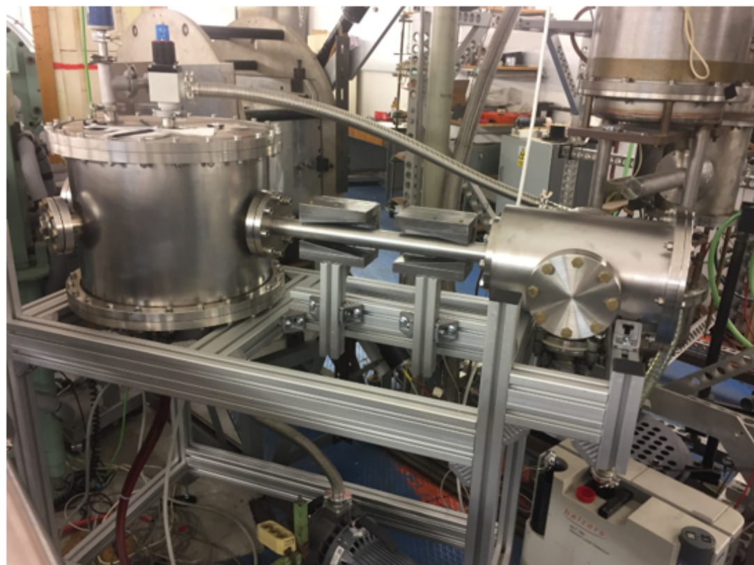
Рис.4 Установка для повышения поляризации пучка нейтронов ускорителя VdG, изготовленная в ЛЯП ОИЯИ (Прага).
