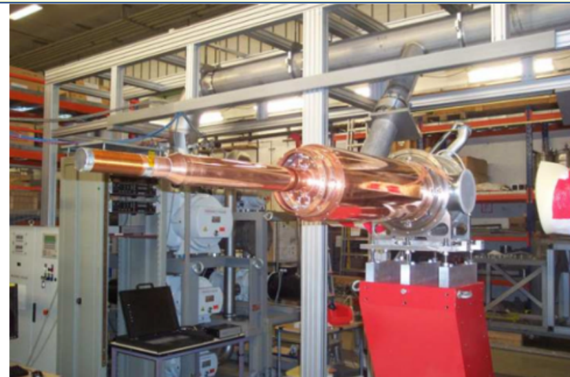
Рис.2 Криостат поляризованной мишени созданный в ЛЯП ОИЯИ (Майнц).
