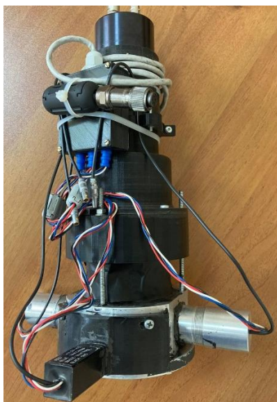
Рис. 5: Мюонный триггер и проведение тестирований в TUM.
