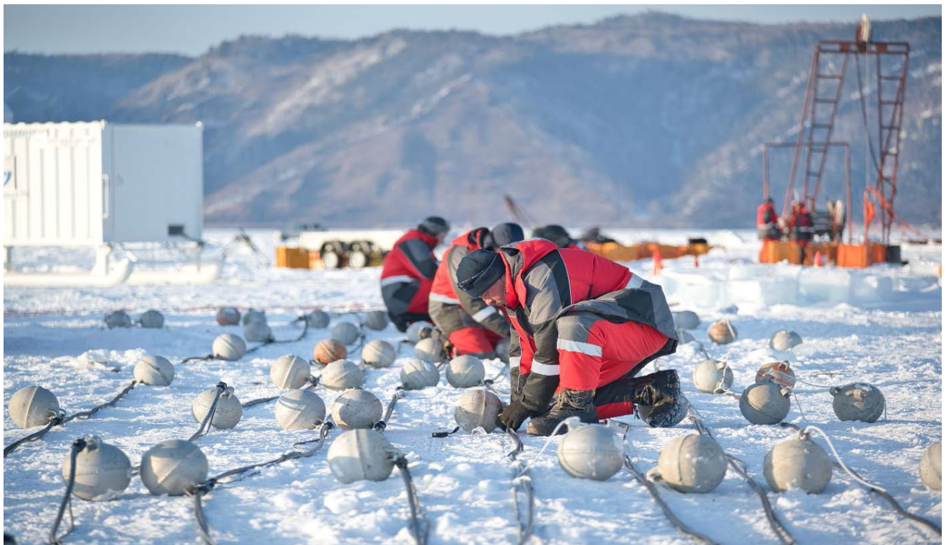
Рис. 3: Сборка гирлянды кластера установки Байкал-ГВД.
