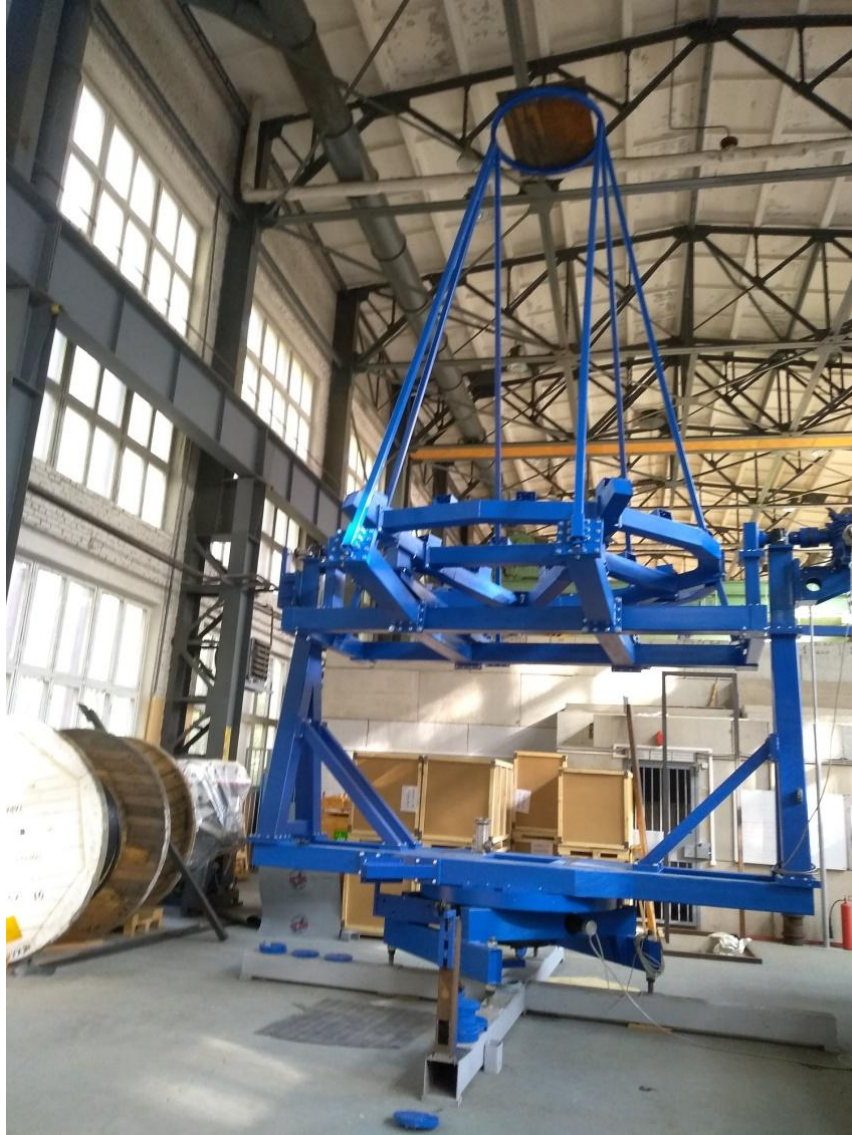
Рис.7. Монтаж IAST#3 в сборе в мастерской ОИЯИ
