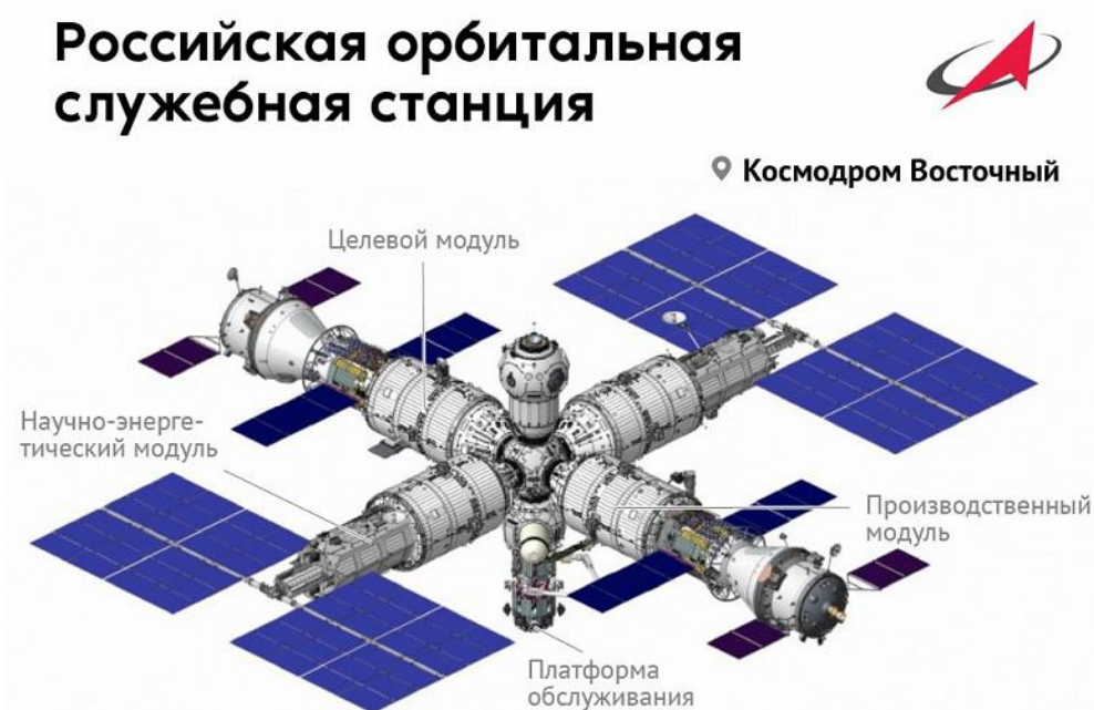
Рис.2. Схематический вид Российской Орбитальной Станции (РОС).
