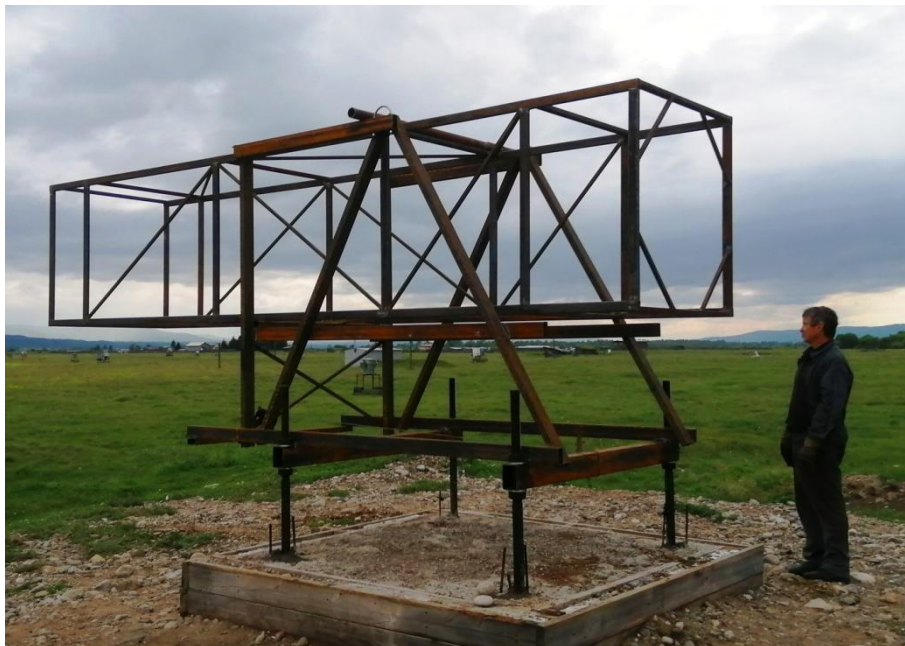
Рис 23. Металлический каркас механической части телескопа
