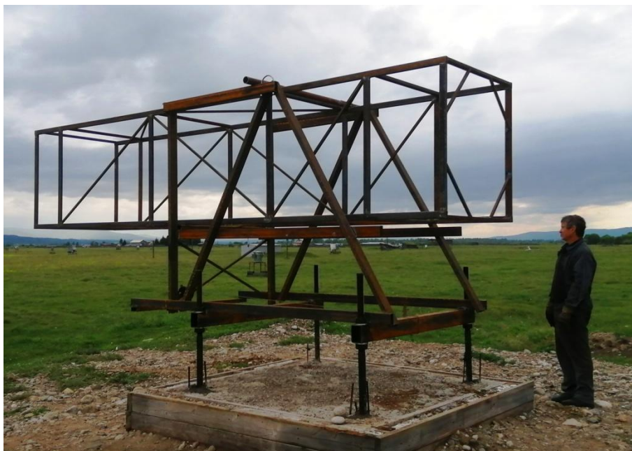
Рис. 17. Металлический каркас механической части телескопа
