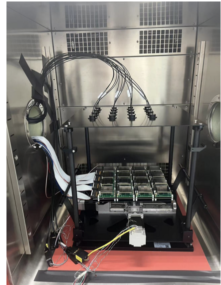
Рисунок 12. Общий вид внутренней части сканирующей системы SiPM: слева — конструкция, справа — реальное устройство.
