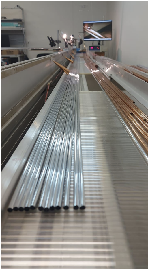
Рисунок 11. 5м строу для STT прототипа, произведенные в ОИЯИ.
